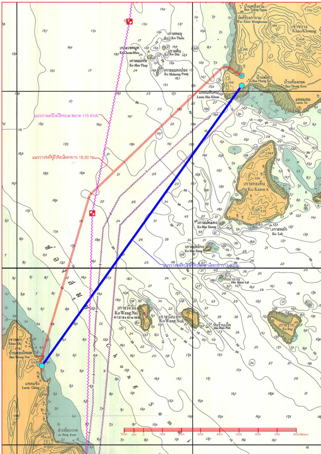
รูปที่ 4.9 แนววางท่อส่งน้ำ ที่เลือกโดยบริษัท ทีม คอนซัลติ้งเอ็นจิเนียริ่งแอนด์แมนเนจเม้นท์ จำกัด (แนวเส้นสีน้ำเงิน) และแนววางท่อที่ผู้วิจัยเลือก (แนวเส้นสีแดง)
